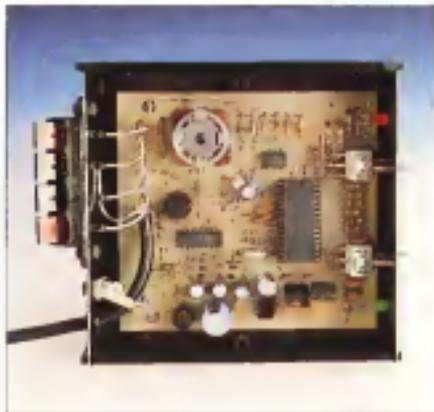
L'interno del MD500 nelle versioni per C&M ed IBM: come si nota le differenze sono minime. Il grosso pulsante (quando in una macchina è stato nell'altro) serve al modo Loopback, nel quale si può controllare l'integrità del collegamento al computer.
